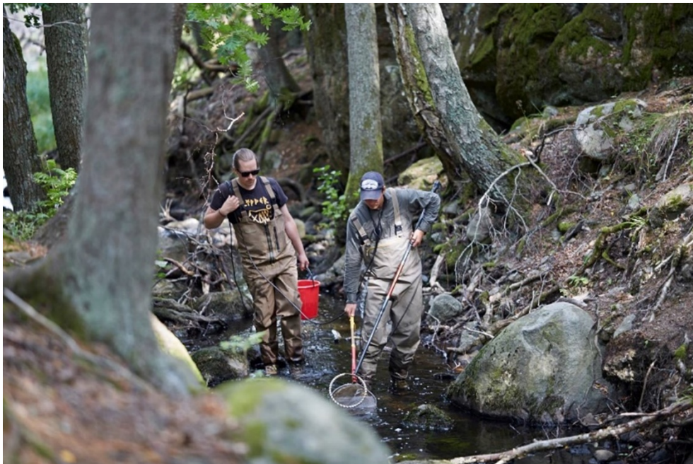
Figur 4. Bilden visar hur ett elfiske bedrivs praktiskt. Pluspolen är den runda ringen i bild. Foto: Michael Wzdulski.
