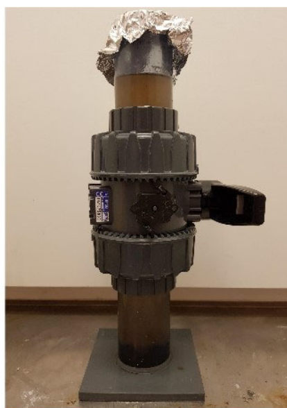
Figur 3. Ett torrt mortlat sedimentprov från Hammarösjön, Vänern (vä), och separertratten (hö) fylld med sediment och zincklorid ( \approx 1.6 g/mL). När bollvalvet stängs kan mikroplasterna som flyter i den övre delen separeras från sedimentet på botten.
