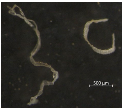
Figur A5. Karakteristiska PVC-fragment i provet från Visingsö med samma utseende som fragment i blankproven.
