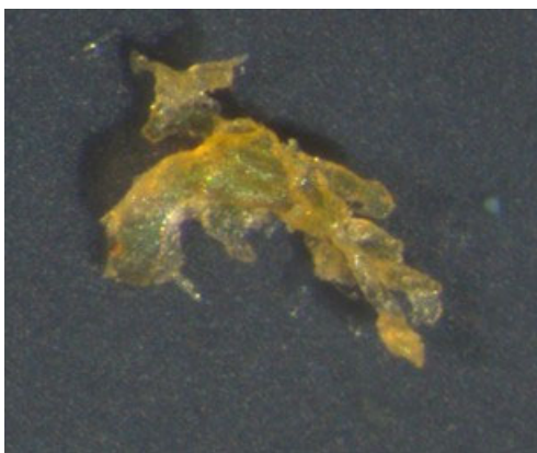
Figur 4. Kontaminering i ett av blankproven i form av ett orange plastfragment från separertrattens bollvalv.
