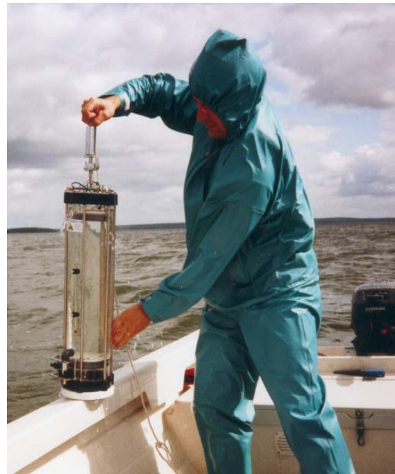
Figur 4. Djurplanktonprovtagning med hjärtklaffhämtare. Foto: ALcontrol ©.
