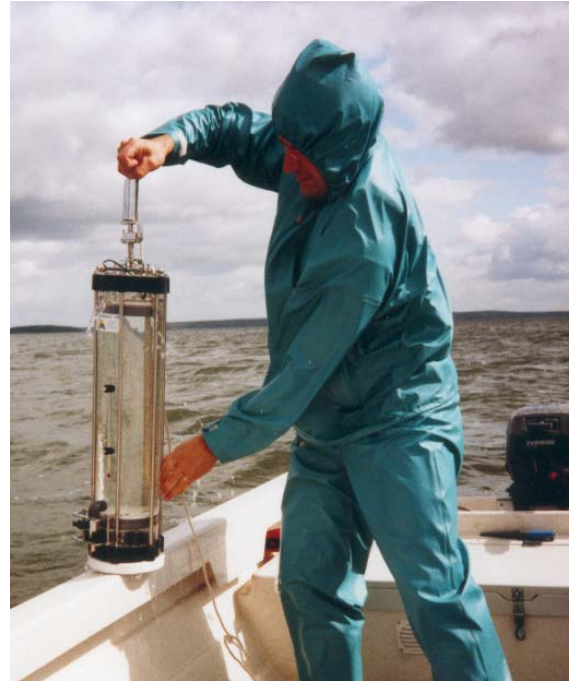
Figur 4. Djurplanktonprovtagning med hjärtklaffhämtare. Foto: ALcontrol ©.
