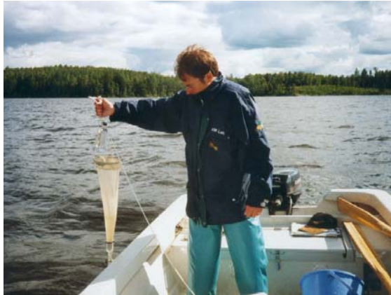
Figur 3. Planktonprovtagning med planktonhäv. Foto: ALcontrol ©.
